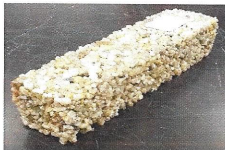
Dimensões dos provetes 160 \pm 5 mm x 40 \pm 5 mm x 40 \pm 5 mm
